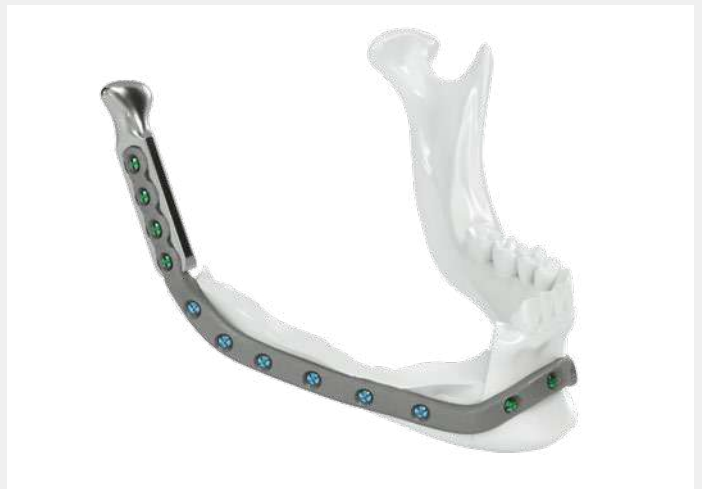
Reconstrucción de la mandíbula sin planificación de trasplante Tratamiento con placa IPS® confeccionada de forma aditiva e implante de cóndilo temporal. Fijación con tornillos de ángulo fijo y estándar.
