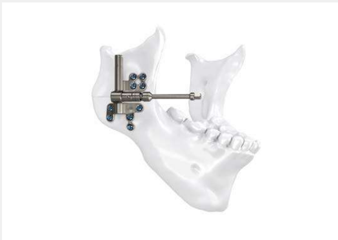
Distracción unilateral de la rama ascendente Distractor Right Angle Driven (con tracción en ángulo recto) personalizado con husillo acortado y placas de fabricación individual. Fijación con tornillos estándar de 1,5 mm.
