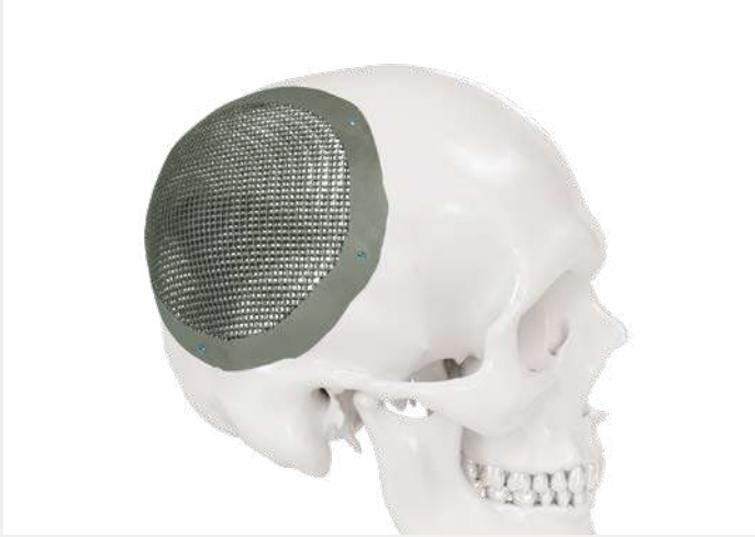
Reconstrucción craneal con implante de titanio de fabricación aditiva Tratamiento con implante de titanio sinterizado por láser con estructura reticular osteoconductiva
